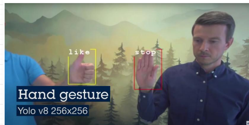
Рисунок 6. Демонстрация работы модели распознавания жестов на микроконтроллере STM32N6 *
